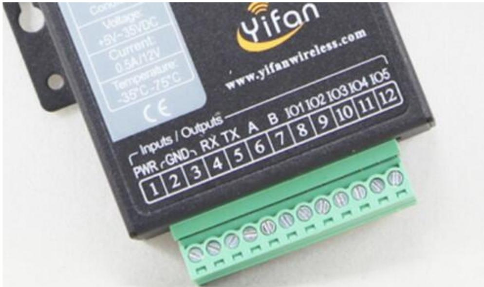
IO1: Digital input/output 0---3.3V
